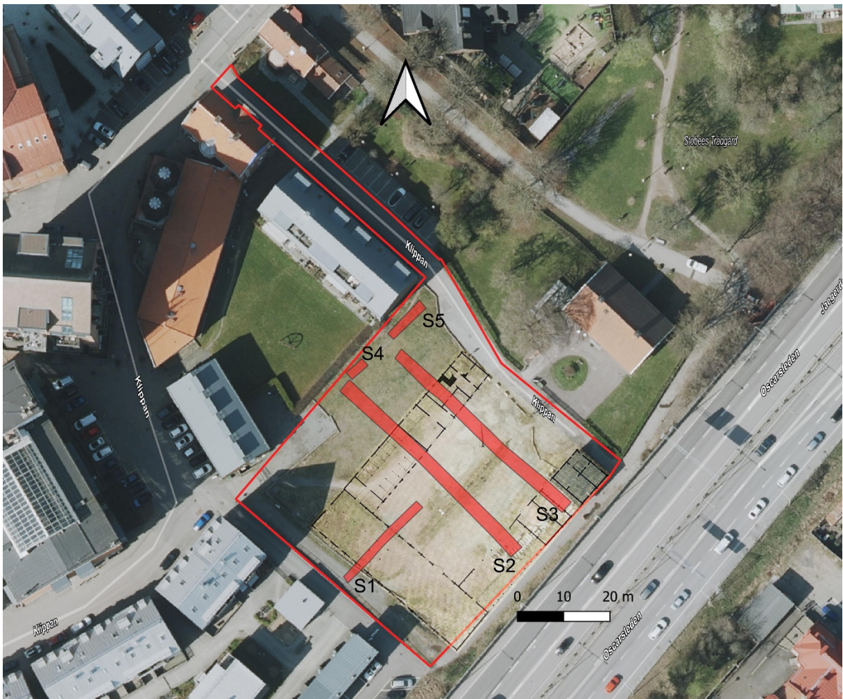
Figur 1. Undersökningsyta med grävda schakt.
